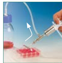
Aspiración con válvula de modo invertido
