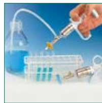
El filtro se adapta a la boquilla con Luer Lock
